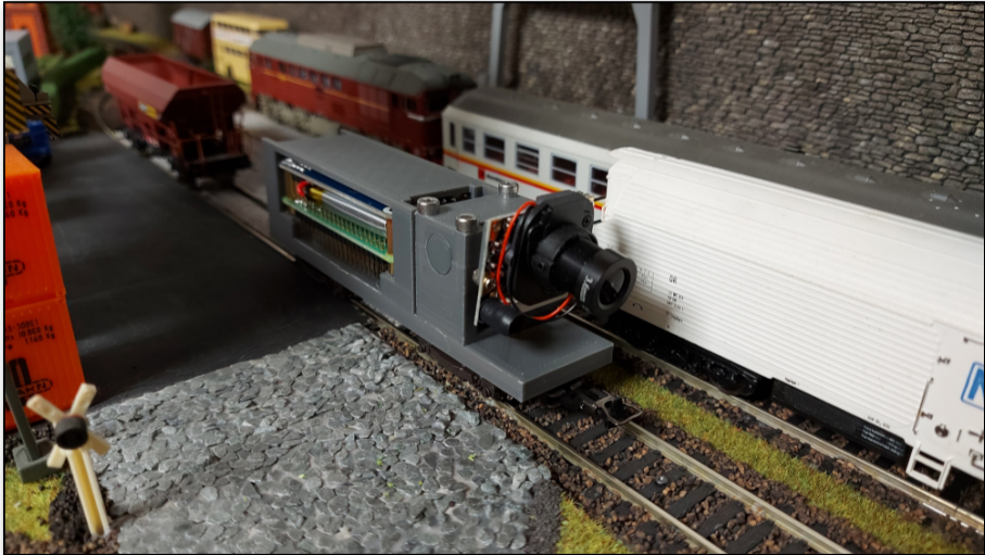
Kamerawagen mit Linux (H0-Modelleisenbahn)
