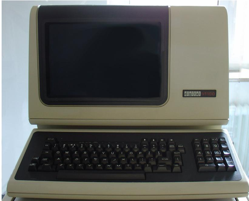
Das VT100-Bildschirmterminal, von DEC ab 1981 produziert, ist vermutlich neben dem **IBM 3270** Terminal das berühmteste Terminal aller Zeiten. Praktisch jedes heute existierende Terminal-Emulationsprogramm läßt sich so einstellen, daß es kompatibel zum VT100 ist; meistens ist der „VT100 Mode“ sogar der **default** (Weglaßwert).
