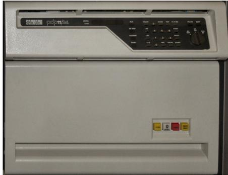
(1979) 16bit-Rechner, 110.000 DM, 256 kB Hauptspeicher, 10 MB Festplatte. Auf diesem Rechner entwickelte Klaus Wirth sein **Modula-2**; auch Unix war für diese Maschine verfügbar. Mit ca. 60.000 Einheiten war das Modell 11/34 das erfolgreichste aus dieser Familie. Der Rechner in unserer Ausstellung stand in Ravensburg in einer Forschungsstation der Tübinger Psychologie (Prof. Preilowski).
