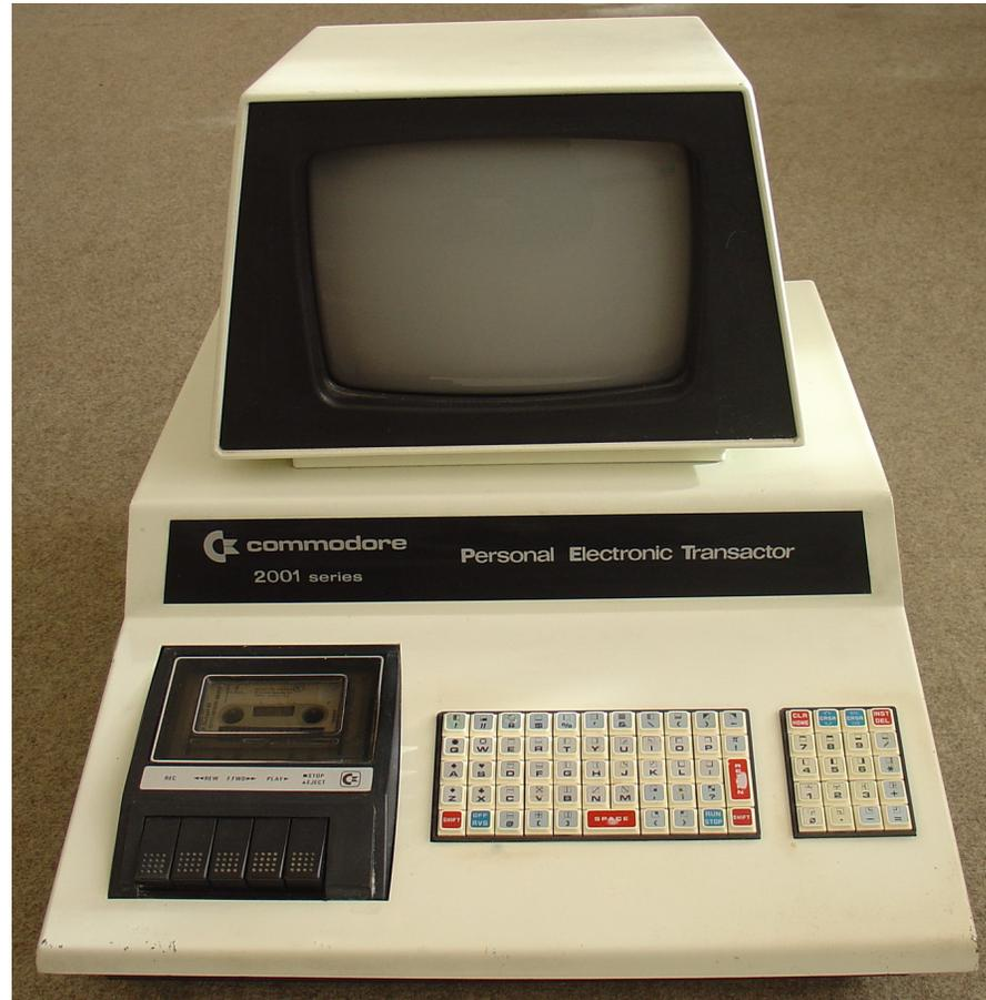
9" Monitor, 25×40, 6502 Prozessor (1 MHz), 4 kB Speicher, Microsoft Basic im ROM, „Mickey-Mouse-Tastatur“, bei Quelle für 2.999 DM.
