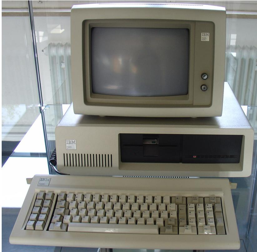
(1984) 22.088 DM ohne Bildschirm und Tastatur, 10 MB Festplatte, 256 kB Hauptspeicher, Microsoft BASIC im ROM, aber kein Cassettenanschluß mehr. Prozessor 8088 ist äußerlich ein 8-bit-Prozessor, im Inneren aber 16 bit.
