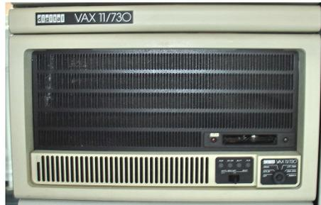
(1982) Die Erweiterung der PDP-11-Reihe um einen virtuellen Speicher. **VAX=Virtual Address Extension**. Das Betriebssystem **VMS** ist heute noch modern und hat als Vorbild für **Windows NT** gedient. (**VMS**→**WNT**). Die **VAX**en sind neben den IBM-Großrechnern **die** Maschinen, mit denen das Internet großgeworden ist.
