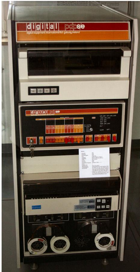
(1970) 13.000 DM, 12 bit Rechner, 4 kB Hauptspeicher, der erste verbreitete Minicomputer und bis 1970 der günstigste Rechner überhaupt. Bis 1990 ca. 300.000 mal verkauft. DECtape TU-56 ( $\approx$  285 kB) als Speichereinheit
